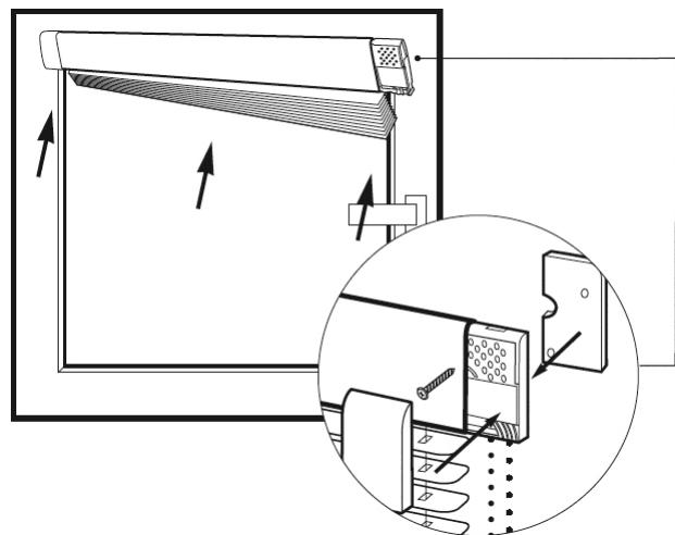
5. Просверлить два отверстия в нижнем штапике.
