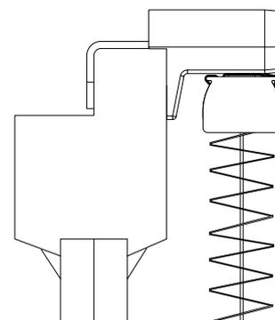
**Накидные кронштейны ПВХ** устанавливаются без сверления только на створку окна ПВХ (подробнее см. спец. инструкцию по монтажу кронштейнов ПВХ). При наличии подоконных кронштейнов, опора прикручивается к кронштейну ПВХ при помощи шурупов  $\varnothing 3,5 \times 6,5$ . Опоры на правые кронштейны крепятся в правые отверстия, на левые соответственно в левые.
