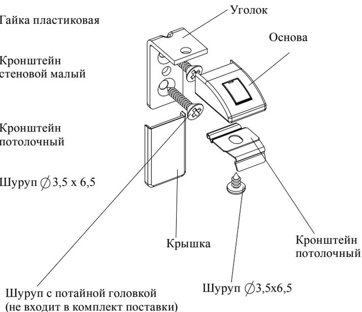
При наличии подоконных кронштейнов, опоры для них крепятся на стеновые кронштейны при помощи винта М3х6 и гайки М3 как показано на рисунках ниже. Опоры на правые кронштейны крепятся в правое отверстие, на левые соответственно в левое. Стеновые закрытые кронштейны уже имеют опоры, на которые надеваются подоконные кронштейны.
