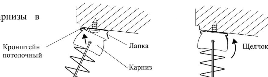
5) Надеть подоконные кронштейны (если есть) на установленные опоры. Шнуры должны выходить с внешней стороны изделия (Регулировка см. п.4).
