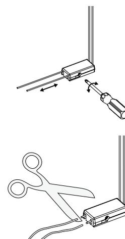
Натяжение тросов в потолочных моделях P3xxx осуществляется при помощи звездообразного ключа TX20 (входит в комплект). Для этого ослабить натяжитель в неподвижном карнизе, натянуть трос, закрутить натяжитель.
