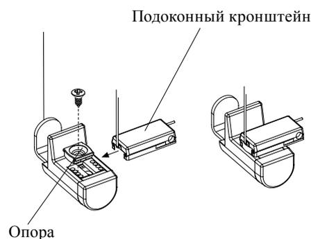
**Кронштейны на штапик** крепятся к штапику при помощи двух шурупов  $\varnothing 2,9 \times 13$ . Потолочные кронштейны к ним крепятся шурупами  $\varnothing 3,5 \times 6,5$ . Кронштейн закрывается крышкой.
