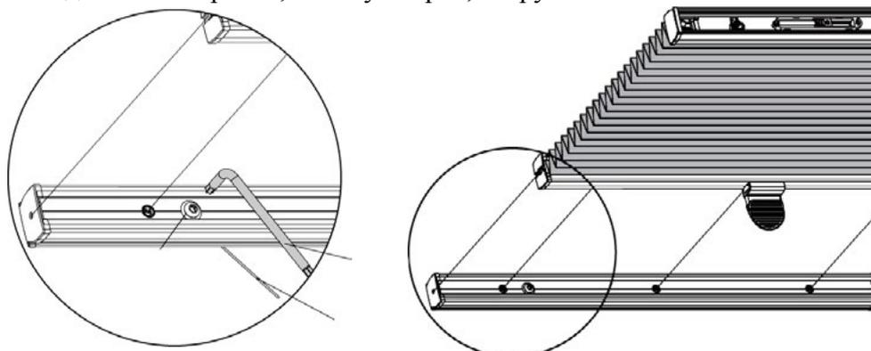
Регулировка натяжения троса в моделях P3xxx.
